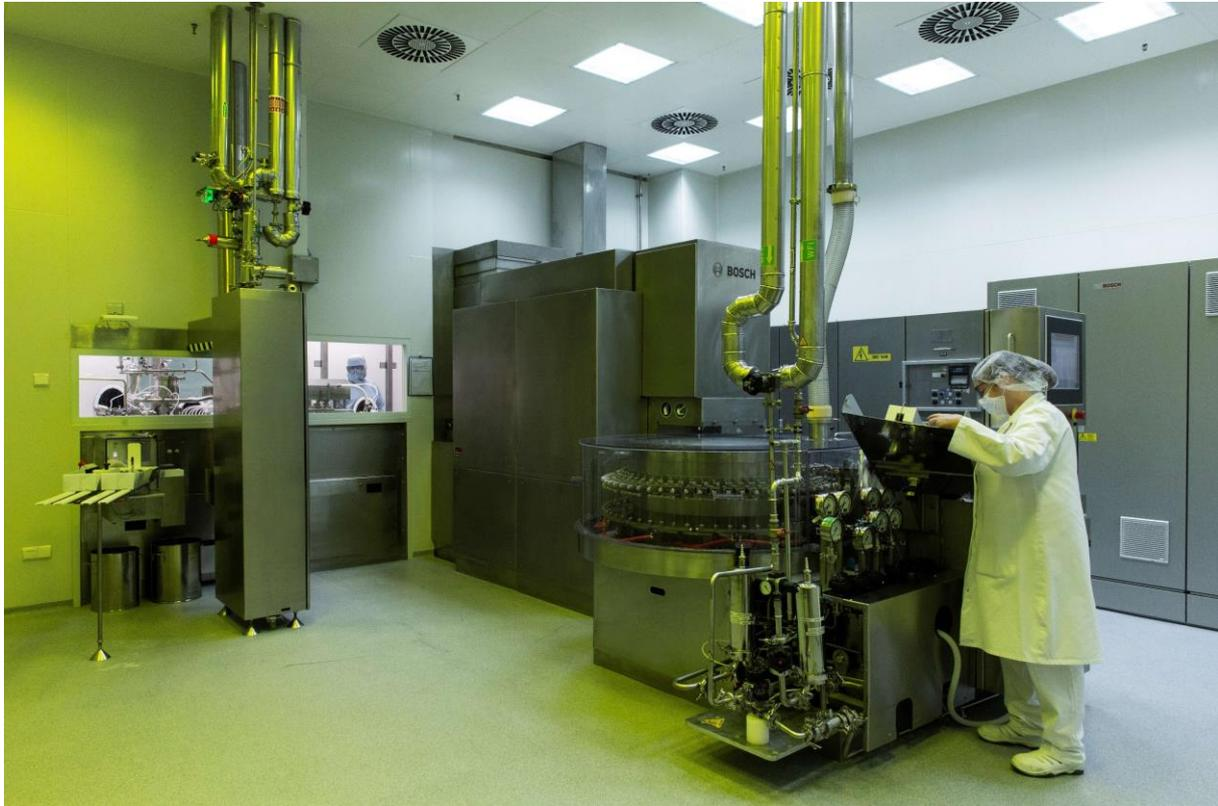
Mit der neuen sterilen Abfüll-Linie können insgesamt 100 Mio Ampullen und Vials im Jahr bei Aenova in Gronau produziert werden; hier der Reinigungs- und Depyrogenisierbereich. (Photo Aenova. Tanita Teichfischer).
